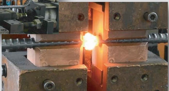
対応ワークサイズ : D10~D16、引張破断強度61,200Nを達成
