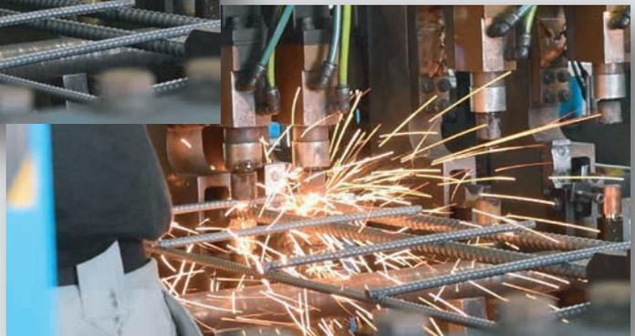
対応ワークサイズ : D10~D22、引張破断強度2,500Nを達成
